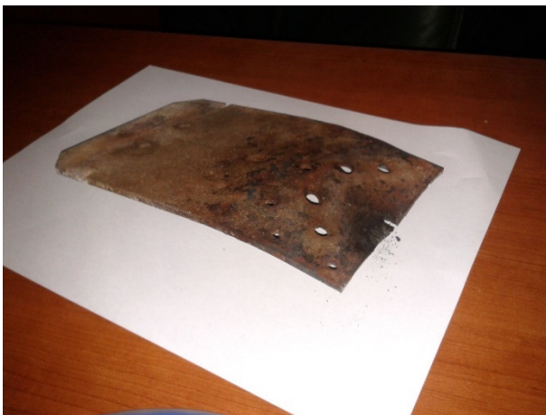
Foto 1 Deformerat rostret & förbränningskammare
